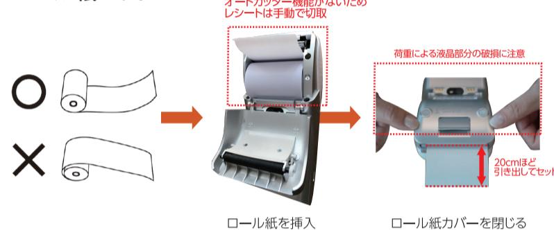
ラベルをはがしてロール紙を引き出し、印刷面を下側にセットします。
