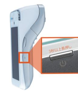
端末側面の電源ボタンを3秒以上押し続ける。
