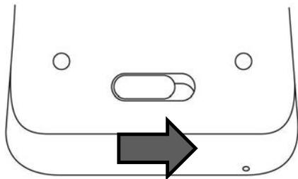
電池カバーのスイッチを右側にずらしてロックをはずします。
