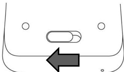
電池カバーのスイッチを左側にずらして確実にロックします。
