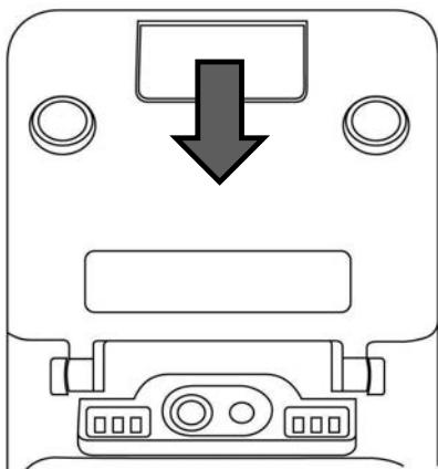
ロール紙カバーのレバーを引き上げて、ロール紙カバーを開きます。
