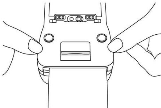
ロール紙カバーの両端に指を添えて、「カチッ」と音がするまで確実に押して、ロール紙カバーを閉じます。
